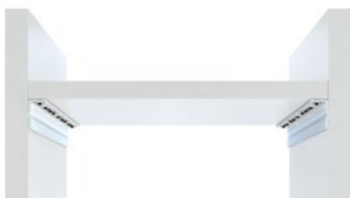
Schemat montażu profilu LED E pod półką.
